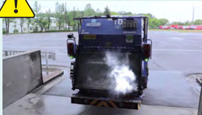
モバイルバッテリーが混入し 発煙したごみ収集車
