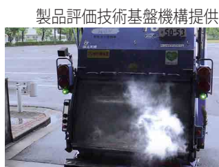
モバイルバッテリーが混入し発煙したごみ収集車
