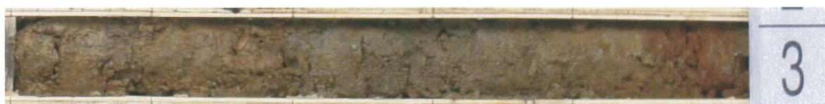
写真 3.2 火山灰土層 (Dv) のコア状況
