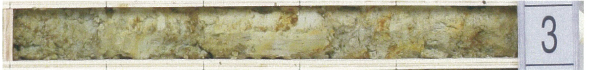
写真 3.3 火山灰質粘土層 (Dvc) のコア状況
