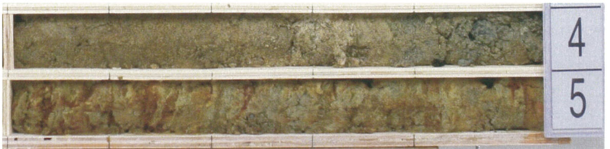
写真 3.4 砂質土層 1 (Ds1) のコア状況
