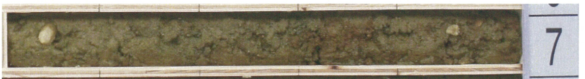
写真 3.5 砂礫層 (Dsg) のコア状況
