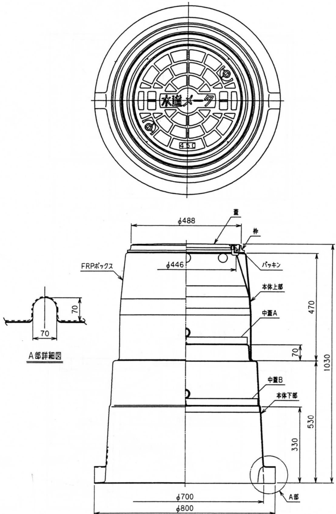
(3) 水道メーター筐 (メーター口径  $\phi 50$  mm以上)
