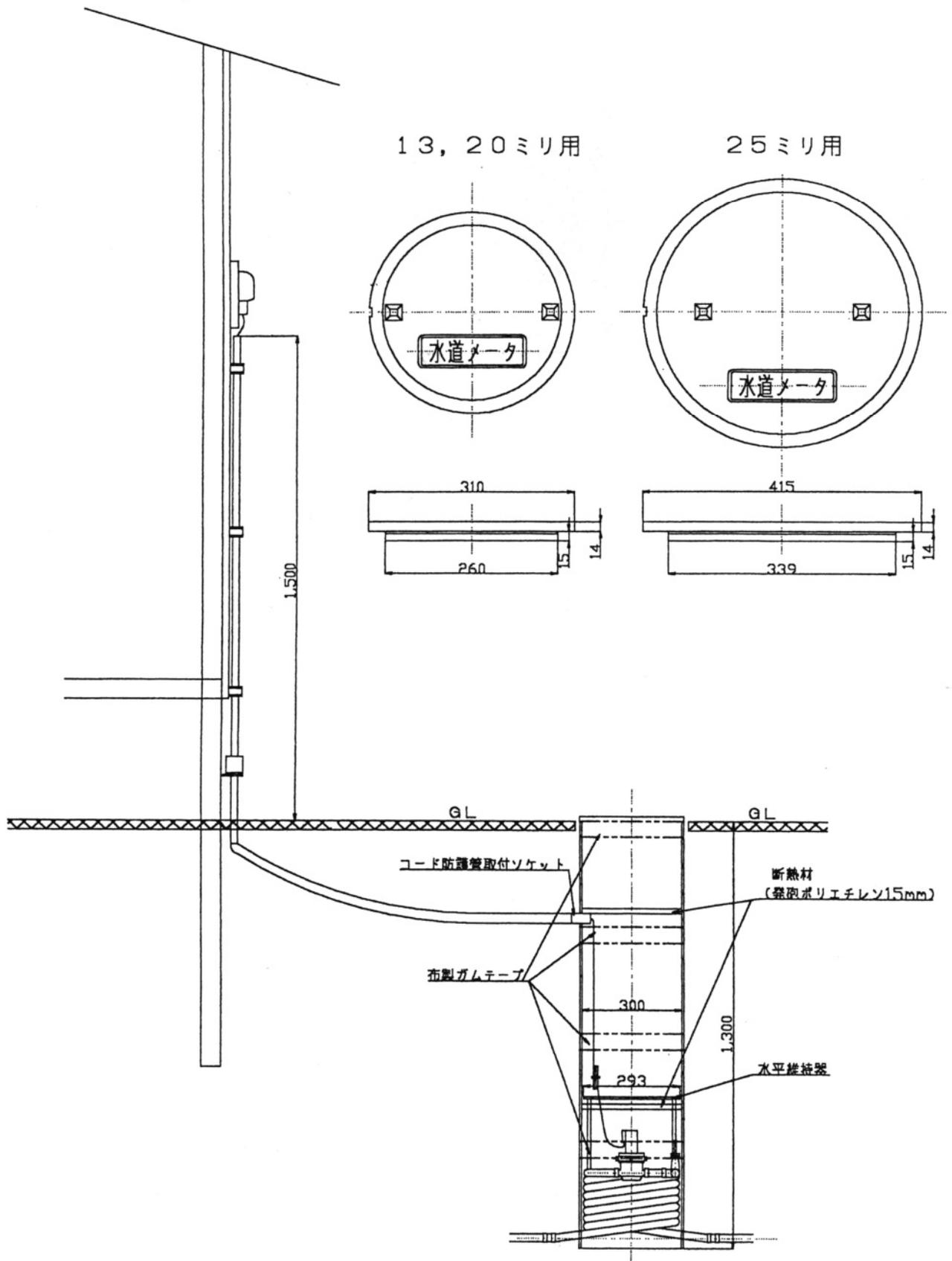
(2) 水道メーター筐 (メーター口径  $\phi 40\text{mm}$ )
